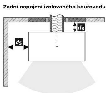
Prostup kouřovodu stěnou z hořlavé hmoty ČSN 06 1008
