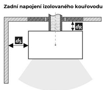
Prostup kouřovodu stěnou z hořlavé hmoty ČSN 06 1008
