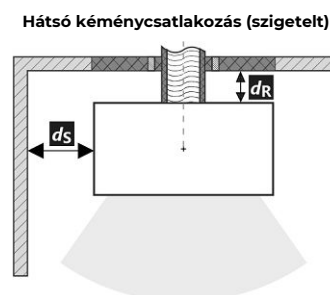
A füstcső áthaladása éghető anyagból készült falon
